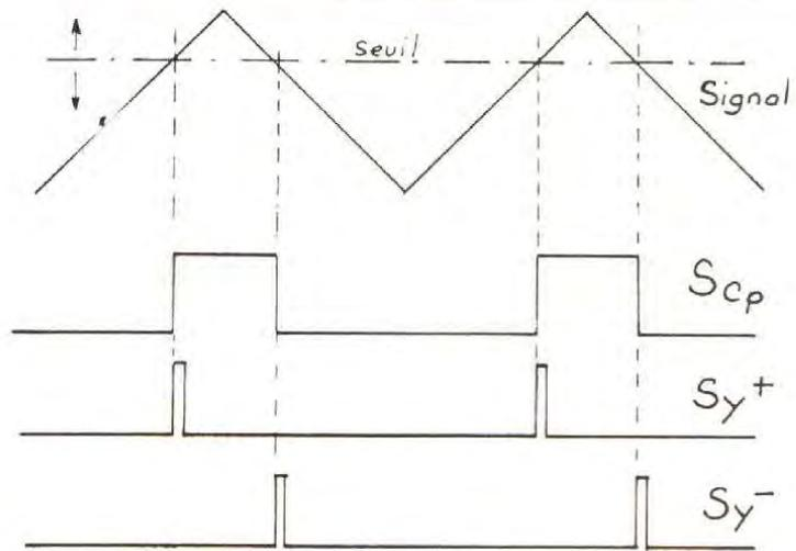
Fig. 7. - Formation des tops de synchro.
