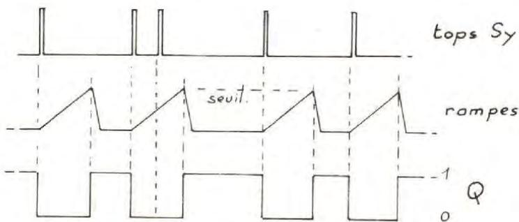
Fig. 3. – Signaux du circuit de la figure 2.
