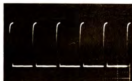
Oscillogramme C. – Un train de six impulsions observé en mode normal.
