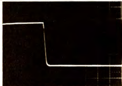
Oscillogramme L. — Le flanc arrière dans tous ses détails, en mode B retardé par A.
