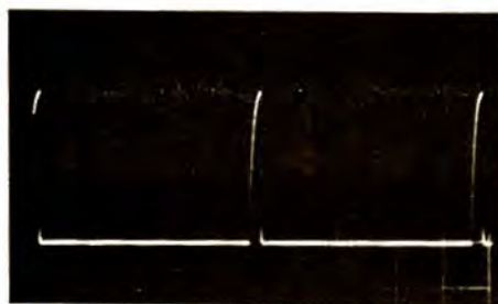
Oscillogramme A. – Observation d'impulsions positives fines. L'impulsion centrale va subir une expansion dans la vue suivante.
