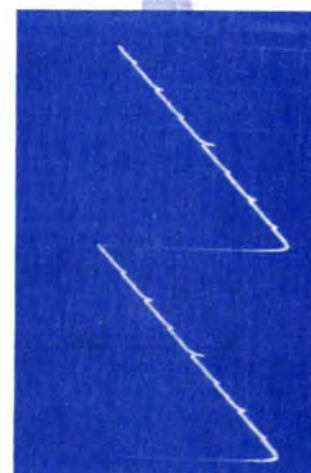
PHOTO F. - Cette fois l'attaque est passée à 700 kHz et les glitches sont très importants. On peut remarquer aussi le temps de descente relativement grand, rendant visible cette dernière.
