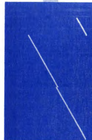
PHOTO C. - Rampe présentant un défaut de monotonie, dû à un réseau R/2R incorrect.
