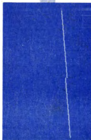
PHOTO D. - Gros plan du défaut précédent. On peut remarquer que les trois derniers échelons de la première partie ont les mêmes niveaux que les trois premiers de la seconde.
