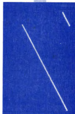
PHOTO E. - Rampe relativement correcte avec une attaque à 25 kHz. On note l'apparition des « glitches ».
