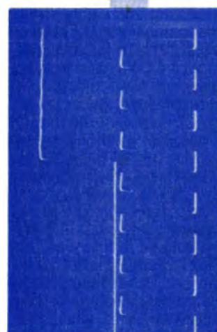
PHOTO H. - Par contre, à 700 kHz, le décalage des fronts des mêmes sorties est important : une demi-période du signal d'horloge.
