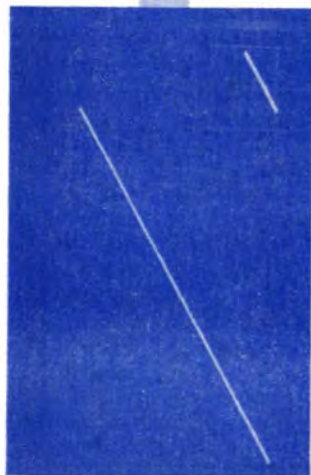
PHOTO A. - Rampe pratiquement parfaite. Attaque à 4 500 Hz. Sortie à 35 Hz.
