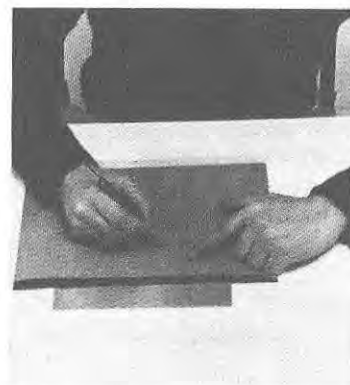
B. Report du dessin sur la plaque avec un papier carbone.
