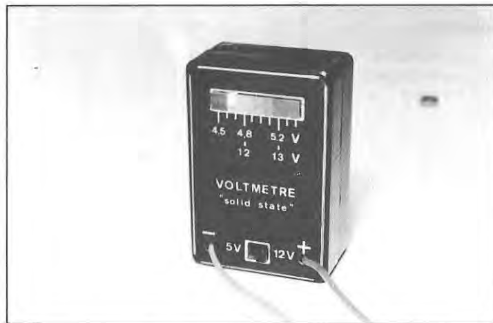
Photo 2.A. - Le voltmètre à Leds dans son boîtier.
