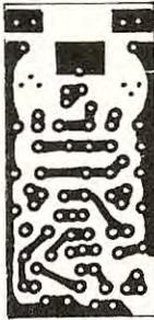
Fig. IX-3. — CI pour ampli à transistors.
