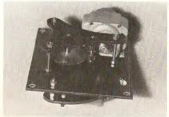
Les photos B et C montrent un tel servo-mécanisme, utilisable sur un bateau et donnant directement les positions droite et gauche, par inversion de sens du moteur électrique. Le retour au neutre étant aussi automatique. Deux canaux sont nécessaires, donc deux relais secondaires.
