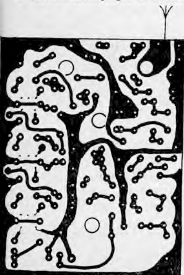
FIG. 7. — Circuit imprimé. Tous les trous de R et C sont percés à 7/10 mm. Noter les fils reliant les broches des transformateurs FI au circuit. La broche centrale du groupe de trois broches, sur ces transformateurs, est inutilisée.
