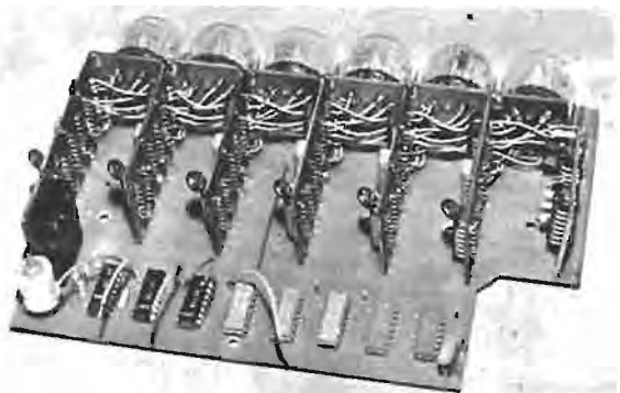
Photo n° 4 : Platine compteur et base de temps, vue de l'arrière. Au premier plan, la base de temps. Les cinq fils visibles rejoignent des douilles de sortie à l'arrière du coffret.
