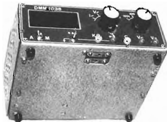
Photo n° 9. Vue sur le dessous du boîtier du DMM1038, permettant de constater la bonne accessibilité des fusibles de protection.
