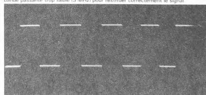
Oscill. 10. Signal TTL, rapport cyclique de 1.
