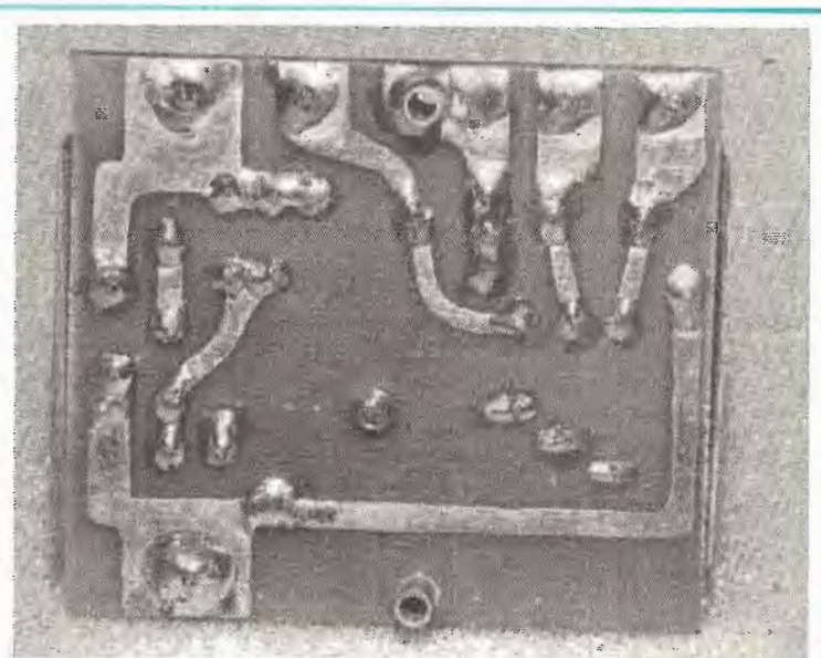
Photo 4 : Le convertisseur de tension, vu côté cuivre.
