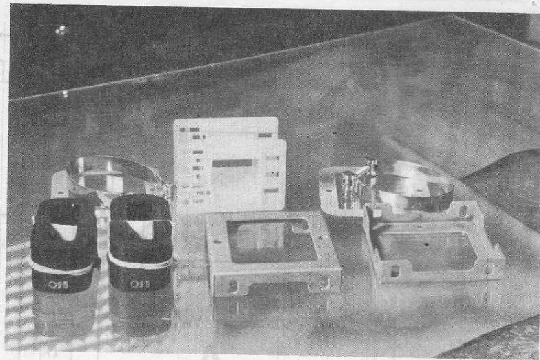
Photo 7. - Les pièces nécessaires à la fabrication du transformateur d'alimentation.
