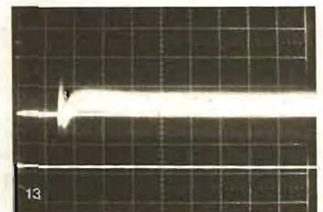
Photo OP13. – Sortie S_v , en vidéo positive, P_2 au max. Objectif bouché. Vert : 200 mV/div. Hor : 2 ms/div.
