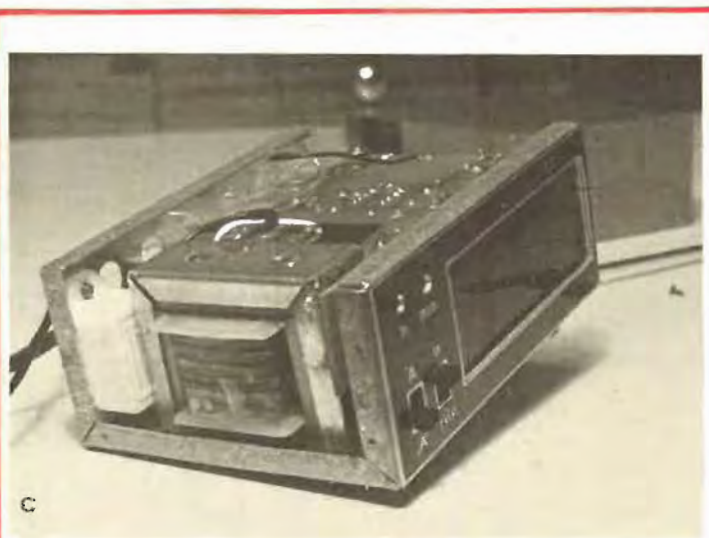
Photo C. – Vue du côté du transfo. On devine que l'espace est mesuré ! Sur le fond, le buzzer d'alarme. La mise à l'heure se fait, avec une tige isolante, à travers les trous de la face avant.
