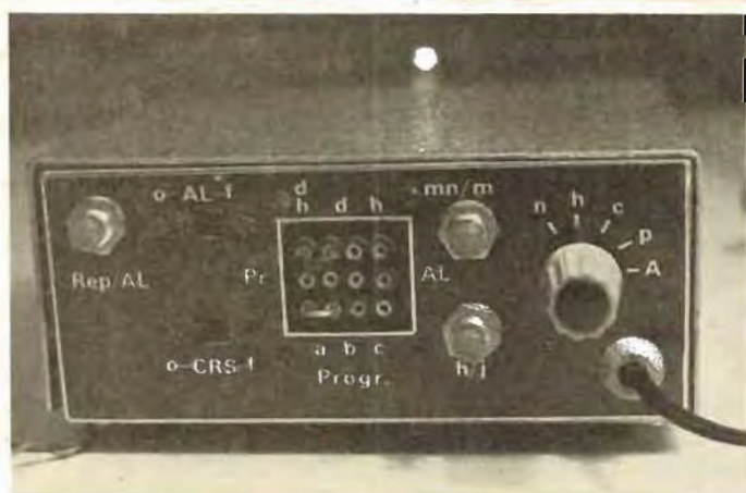
Photo H. - La face arrière de la HRPC6 regroupe les commandes. Remarquer la plaque à bornes, avec en haut la commutation des modes d'affichage, en bas celle des modes de marche du programmeur. Commutation par cavaliers. Au centre, les sorties alarme et programmeur. L'ordre des positions de réglage de S_1 n'est pas tout à fait celui qui est préconisé dans le texte et qui est préférable.
