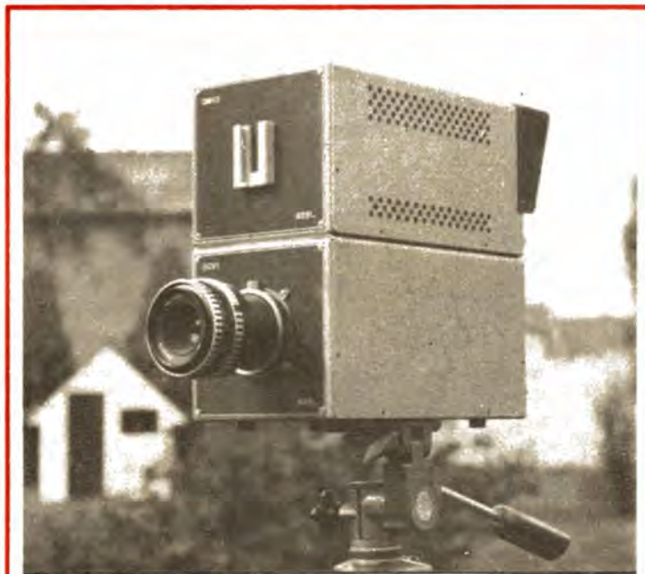
Photo A. - L'ensemble caméra DCV1 et monitor DMV2. Un ensemble de prise de vues TV, noir et blanc de classe professionnelle ! Le support plastique à l'avant du monitor est destiné soit à la pose d'un projecteur d'éclairage, soit à la pose d'une antenne dipole en application « récepteur TV UHF ».
