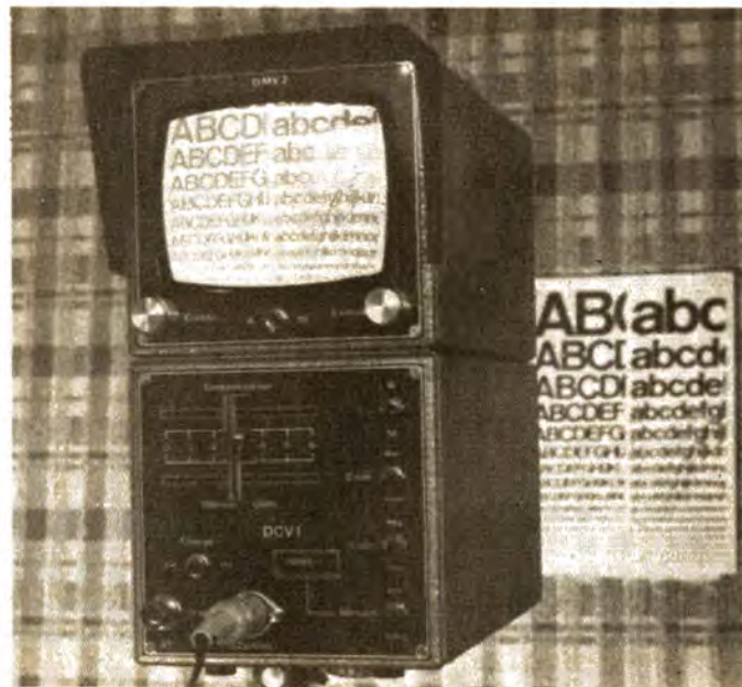
Photo B. - Ce cliché de l'ensemble DCV1/DMV2 en fonctionnement permet d'apprécier la qualité des images ! Le petit défaut de l'image du monitor est en réalité le reflet d'une fenêtre !
