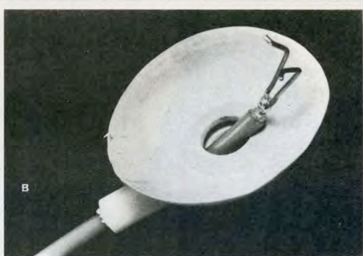
Photo B. — La ventouse de THT, avec la pince à réaliser en fil d'acier étamé.
