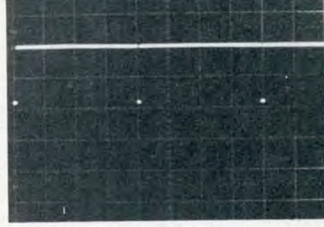
Photo I. — Le signal 4TL. Vert : 20 V/div. La ligne droite indique le niveau du 0V.
