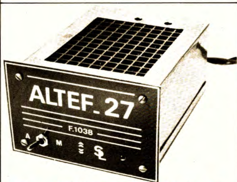
Photo A. - Aspect de l'émetteur d'alarme ALTEF terminé. Remarquer la grille d'aération.
