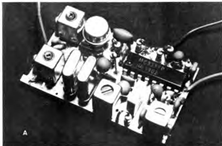
Photo A. — Un récepteur RX9, version 41 MHz, avec filtre FI type CFM2 et entrée directe.
