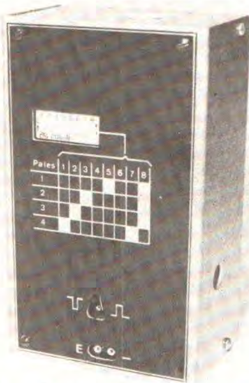
Photo B. — Vue arrière montrant les interrupteurs de programmation et les entrées de l'impulsimètre.
