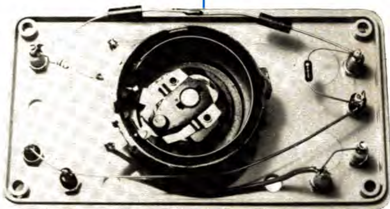
PHOTO A. Câblage du mini-pont. On ne peut guère faire plus simple !
