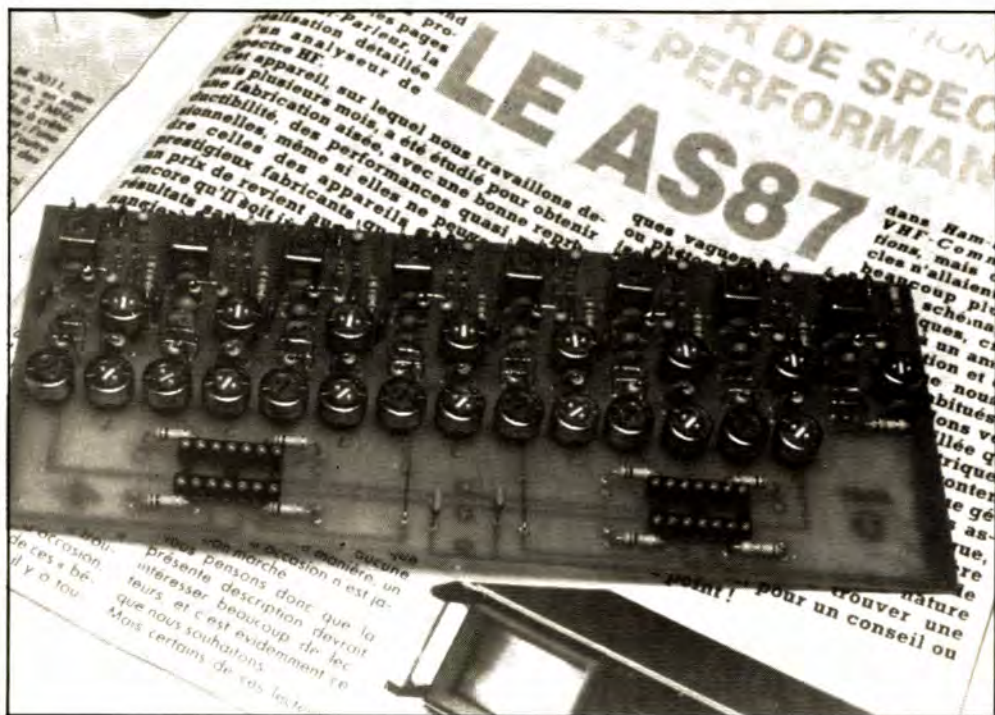
La platine du détecteur LOG/LIN, avec ses composants.
