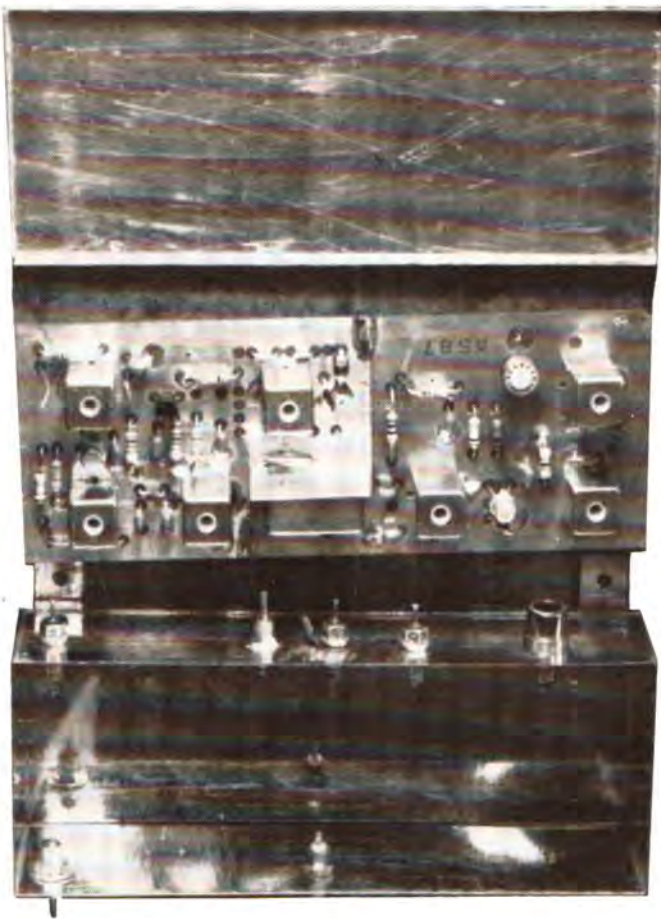
Vue du troisième mixer, juste avant la mise en boîtier. Voir les pièces de passage installées sur ce dernier.
