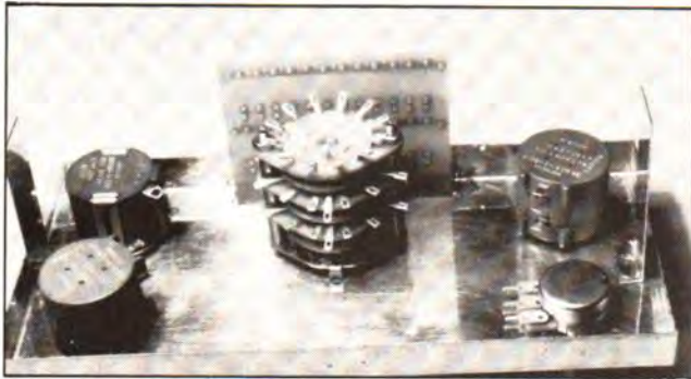
Le socle de la base de temps, équipé des pièces de face avant. Remarquer les entretoises plates pour fixation du CI. Le petit CI annexe correspond à une première version sans ajustables.
