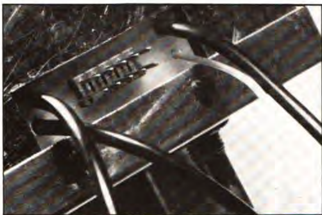
Photo E. - Gros plan sur la sortie des connexions : le connecteur mâle du câble plat et les sorties de fils blindés. Noter la découpe faite dans la ceinture.
