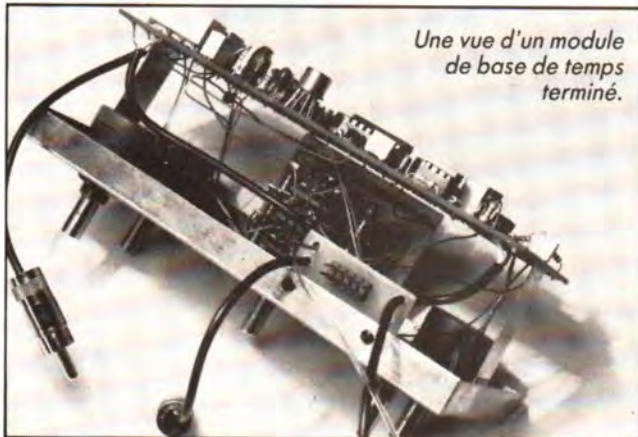
Le socle de la base de temps, équipé des pièces de face avant. Remarquer les entretoises plates pour fixation du CI. Le petit CI annexe correspond à une première version sans ajustables.
