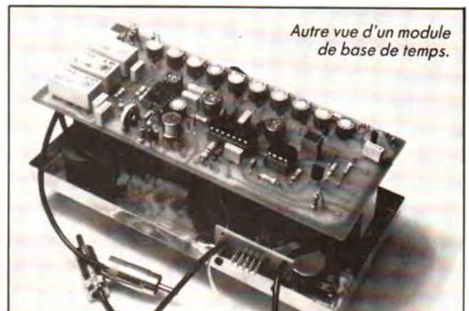
Une vue d'un module de base de temps terminé.
