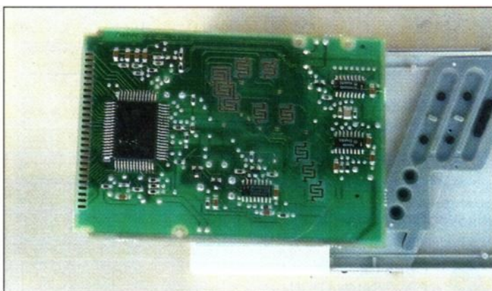
L'envers du décor : microcontrôleur programmé par masque et CMS.
