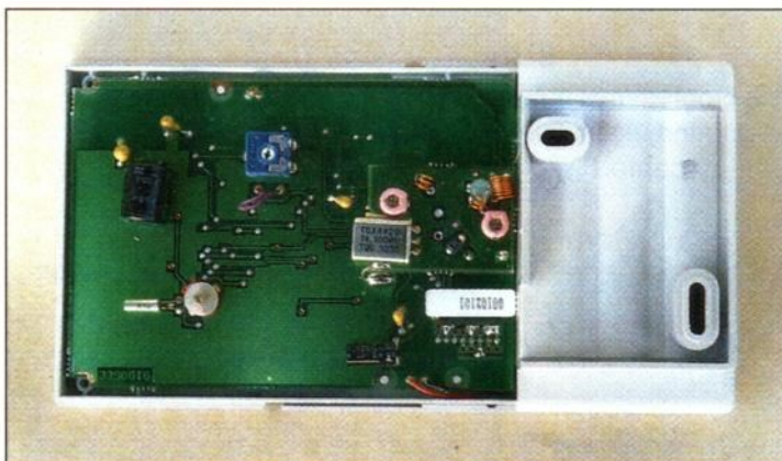
L'arrière du thermostat : remarquez le quartz de pilotage sur le petit circuit imprimé émetteur.
