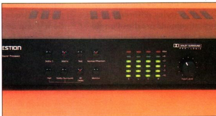
La face avant reçoit une série d'indicateurs de niveau que l'on utilise dans la phase de mise en service et pour détecter les messages codés Dolby. Les touches modifient le mode d'exploitation.
