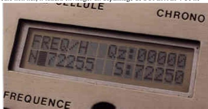
Fonction de programmation de la fréquence d'émission, dans le cas de l'usage de la platine spéciale SUPERTEF, à synthèse de fréquence.
