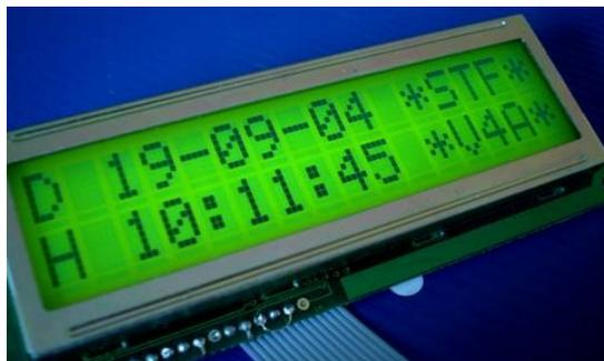
Dans l'écran de service, appuyer sur "P" pendant 1 à 2 s. Vous obtenez l'écran horloge, avec en haut la date, en bas l'heure et à droite, le n° de version logicielle. Comme toute horloge digitale, celle du SUPERTEF est programmable et doit être programmée !
