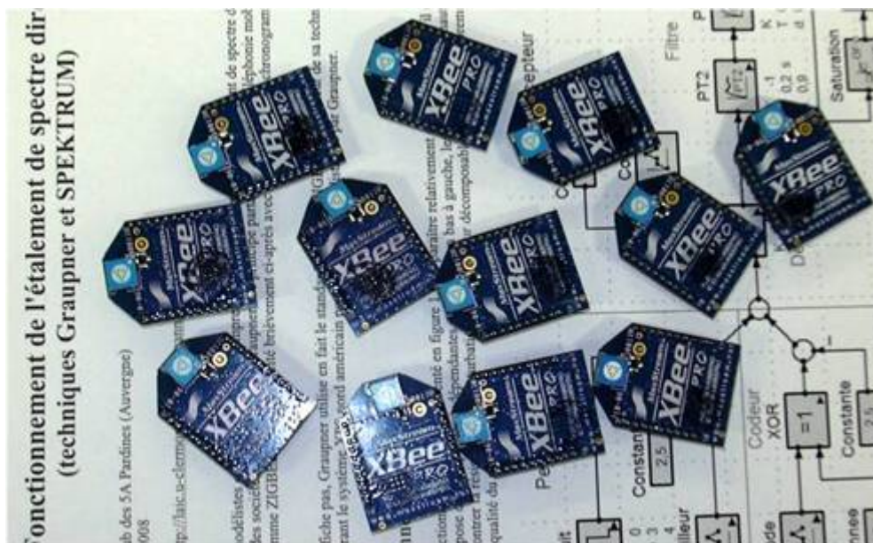
Photo 1 : 12 modules professionnels ZIGBEE capables de partager simultanément la même fréquence sans se perturber mutuellement (modèle XBEE-PRO utilisé entre autre dans le système XPS)
