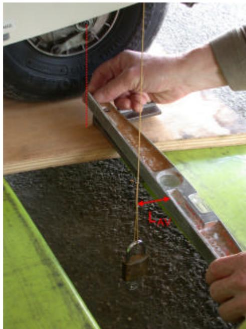
7) Pour le poids sur la roulette arrière, il faut mesurer la projection horizontale de la distance entre le bord d'attaque de l'aile et l'axe de la roue arrière ( $L_{AR}$  sur les schémas 1 et 2).
